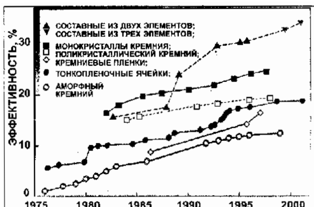
Рисунок 16.13 — Рост эффективности полупроводниковых преобразователей солнечного света в 1975—2000 годах (по Б. Лучкову, 2002)
